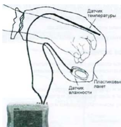
Рис. 17. Схема экспериментальной установки терморегуляции кожи
